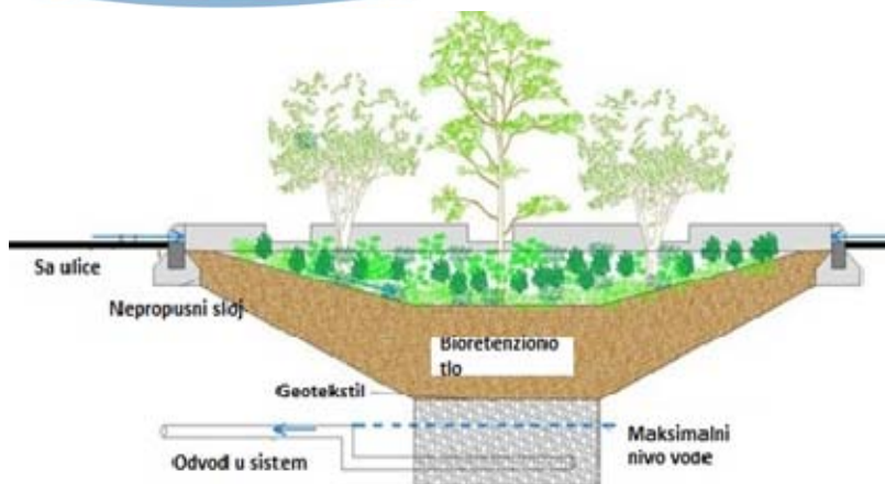
Slika 4.10 – Šema bioretencione uvale sa osnovnim elementima sistema – obavlja fizički, hemijski i biološki tretman atmosfere vode, pogodan za urbane prostore, za slivove veličine do 5 ha.
